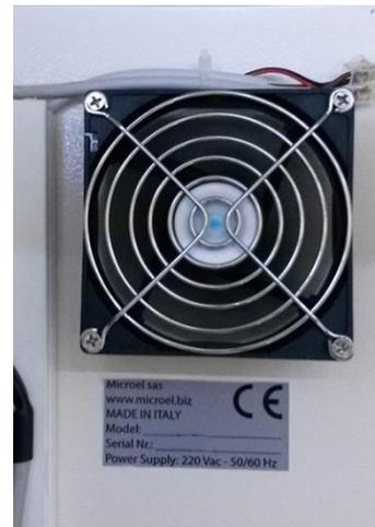
Tale etichetta è applicata all'interno dell'apparecchio, sul fondo della cassa, per garantire la possibilità di lettura del numero seriale anche quando la macchina è stata installata a parete.
